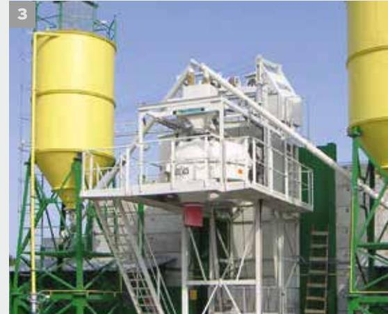
**3 | TRANSMIX THZ 750 - S 4 Sternanlage mit manuellem Schrappwerk TS 12/13**
