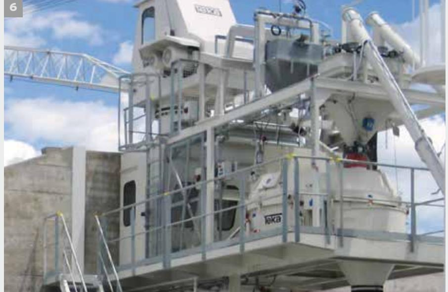
**6** | TRANSMIX THZ 1500 - S 5 Sternanlage mit automatischem Schrappwerk THS 40/20
